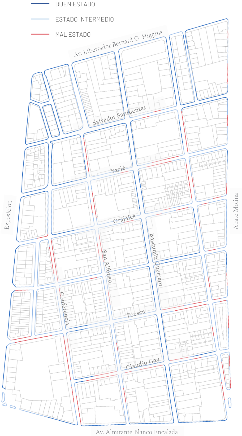
Levantamiento del estado de las veredas.
